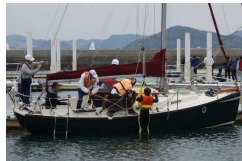
ライフリングを用いてテークル付きのハリヤードで引揚げた例
